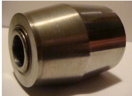
Figure 4.5 Cone-shaped AMB rotor
