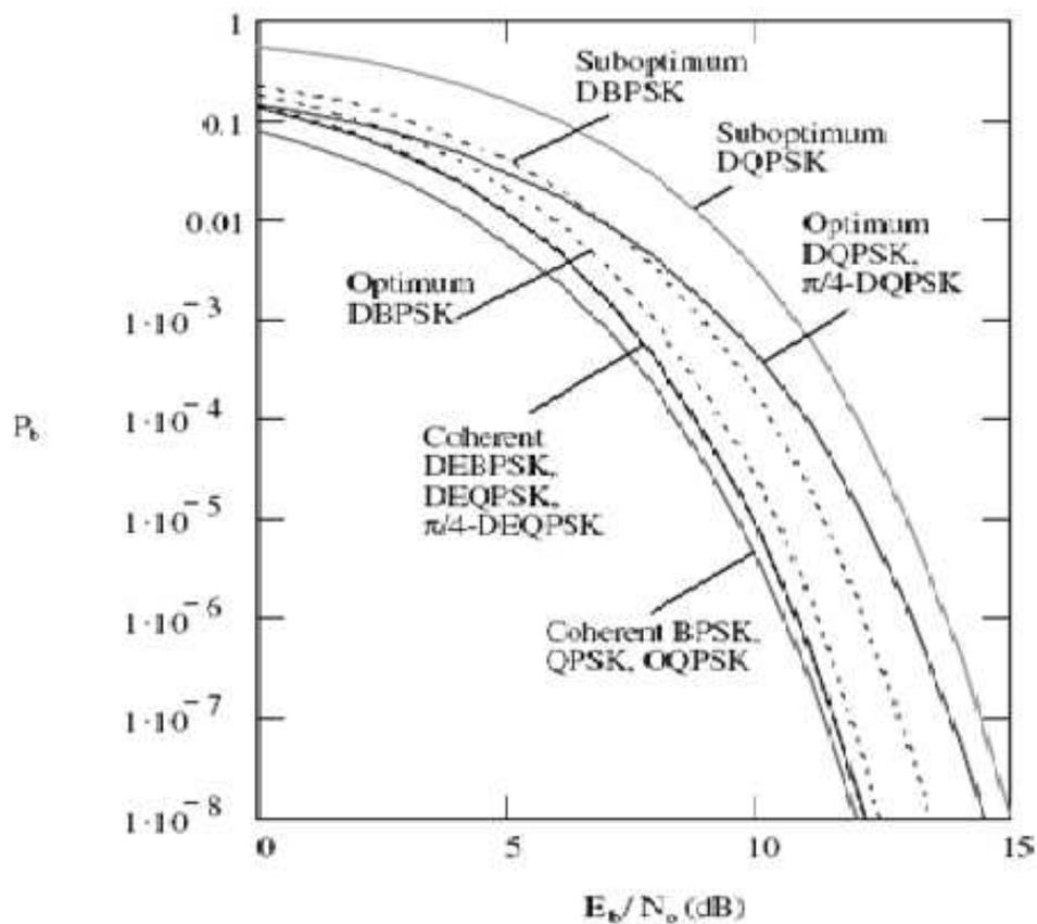
Figure 27: BER Performance for DBPSK and DQPSK [4]
